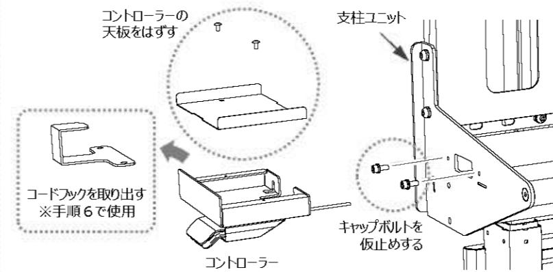
つぎにコントローラーを支柱ユニットに固定します。仮止めしたキャップボルトにコントローラーのスロットを引っ掛け、ボルトを締めて固定してください。
