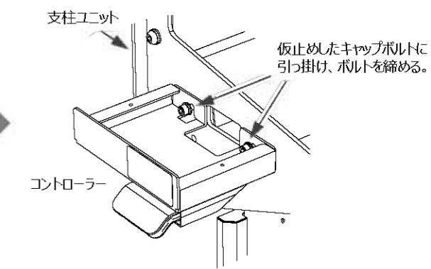
コントローラーケーブルの配線を行います。支柱ユニットの天板をはずし、コントローラーケーブルをコントロールボックスのモジュラージャック (A1) に差し込みます。
