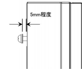
②モニター受金具の上側の孔に先に取付けたネジの頭部を差し込み、支柱に金具を引掛けてください。
