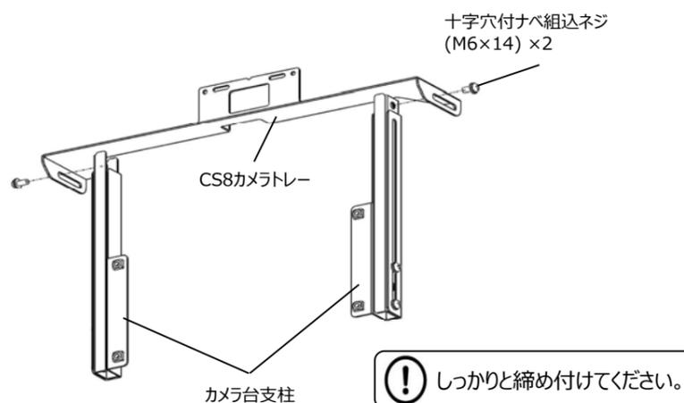
②高さ調整用ネジを緩めて、カメラ台支柱を最大まで伸ばす。
