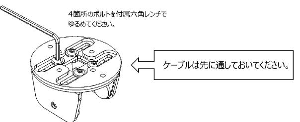
パーティションの幅に合わせて再度締め付けてください。
