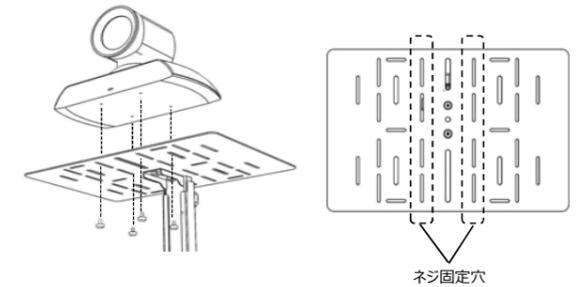
カメラ底面に4箇所ネジ穴がありますので、カメラの位置を調整してから上図のネジ固定穴を使用して付属のM3×8のコリヤネジで4箇所固定してください。
